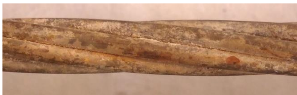
Obr. 7: Lano referenční bez koroze
